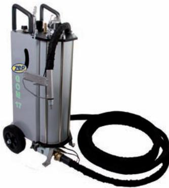
L'aérogommeuse est une machine utilisée pour le décapage de différentes surfaces. Ce procédé, appelé nettoyage par aérogommage, s'effectue par la projection à basse pression d'un mélange d'air comprimé asséché et d'un abrasif naturel.
